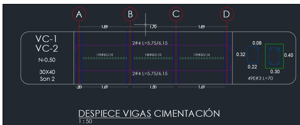
Ilustración 19. Despiece vigas de cimentación.
