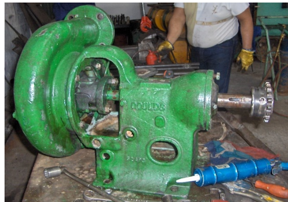
Fig. 7 bomba de crudo de estaciones de bombeo
