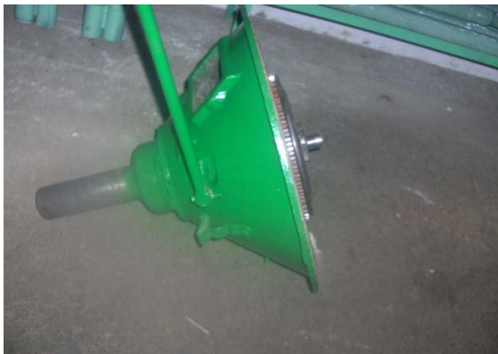
Fig. 6 Clutch de unidad de bombeo mecánico
