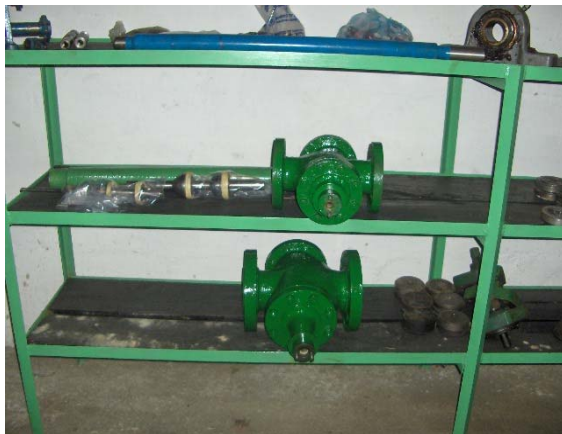
Fig. 4 válvulas de control de 2" y 4"
