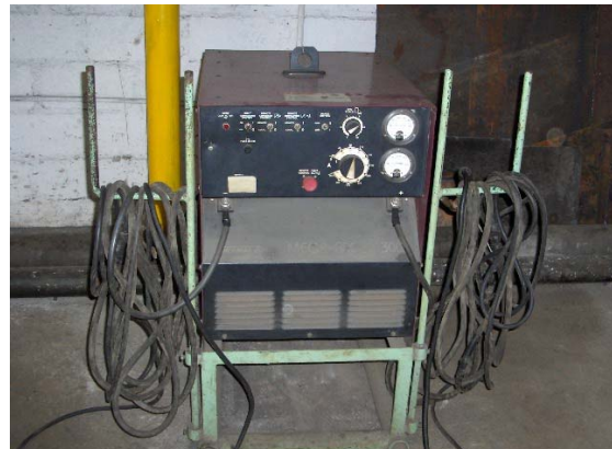
Fig. 21 Equipo de soldadura marca "termal ARC"
