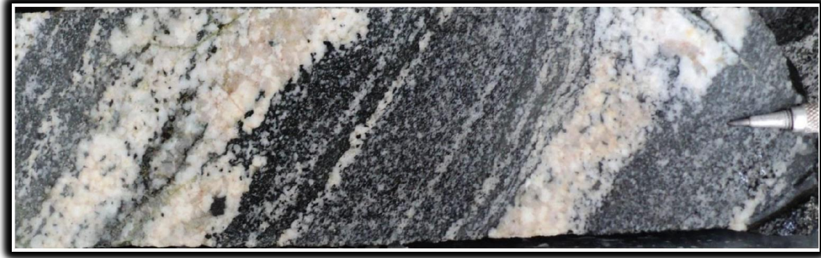
Figura 13. “Neis bandeado con mesosomas de horblenda y biotita y leucosomas de cuarzo y feldespato potásico. Ejemplo de LB112 en 136.80 m”. Adaptado de (MINESA, 2016, p.50).
