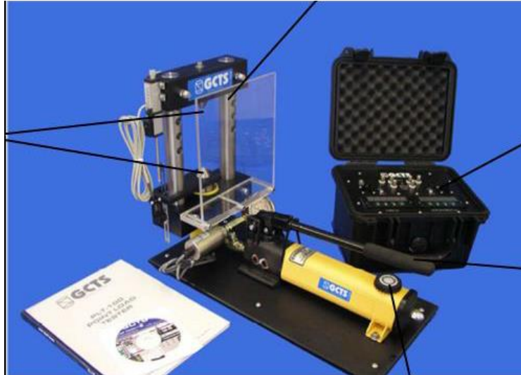
Figura 30. Equipo de carga puntual empleado. Adaptado de procedimiento ensayo PLT (MINESA, 2015, p.6).
