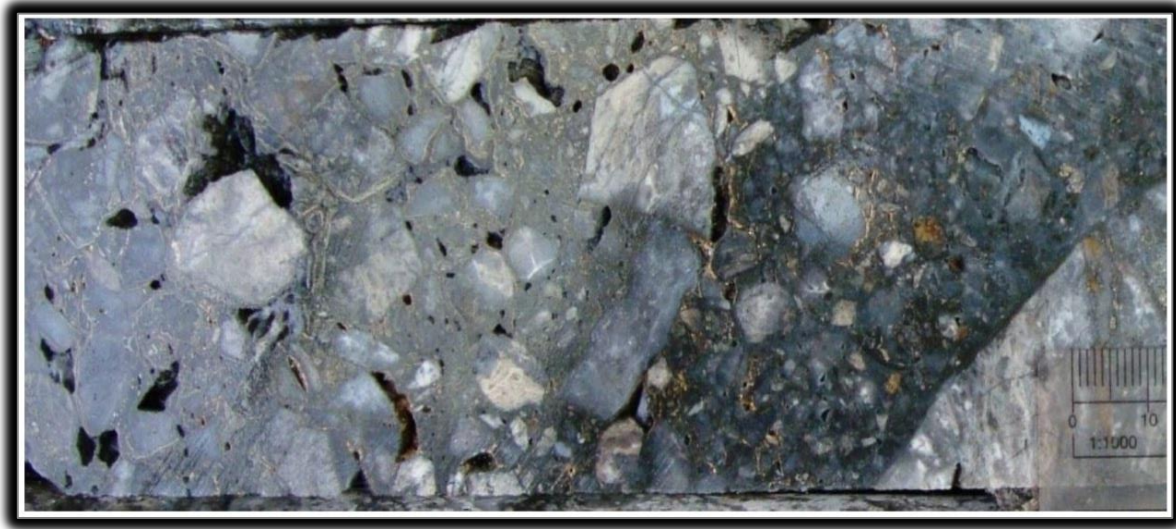
Figura 14. “THBX-QCBX-CPBX. Brecha tectónica-hidrotermal polimíctica clasto soportada. Ejemplo de LB269 en 319.0 m”. Adaptado de (MINESA, 2016, p. 57).
