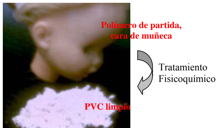
Figura 8. Policloruro de Vinilo antes y después del tratamiento Fisicoquímico
