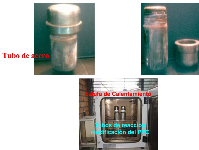
Figura 5. Montaje experimental para la reacción de modificación del PVC
