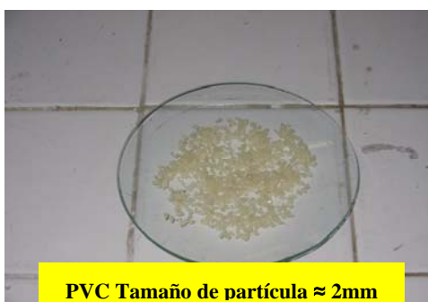
Figura 2. Tamaño de partícula del PVC para la reacción de modificación sin tratamiento Físicoquímico.
