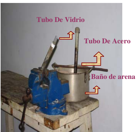
Figura 6. Montaje experimental para llevar a cabo las pruebas de cloros e hidroxilos
