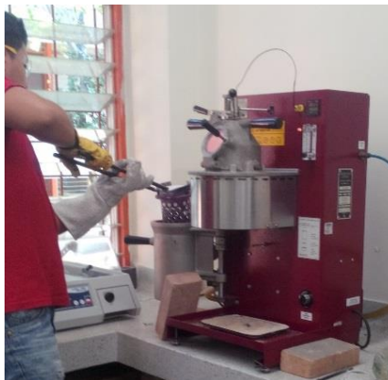
Figura 6. Proceso de Inyección del metal en el interior del molde sin aplicar vacío
