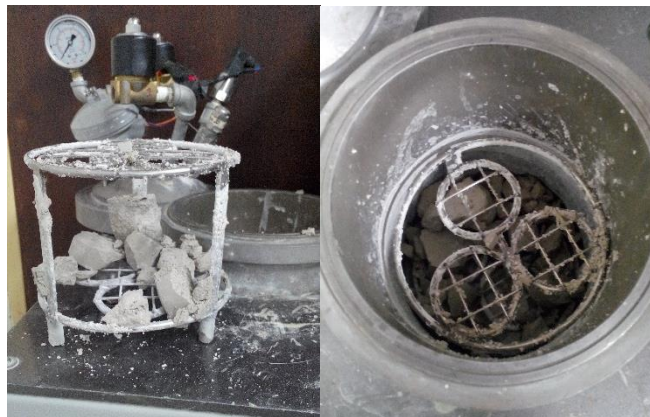
Figura 8. Probetas con revestimiento fabricado con el refractario de magnesita y con una granulometría de -140 mallas destruidas por después del proceso autoclave
