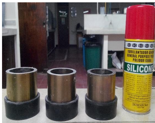
Figura 2. Probetas en acero inoxidable con base de caucho vulcanizado y desmoldeador (silicona).
