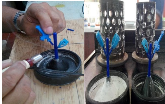
Figura 4. Preparación del árbol en cera en la base de goma
