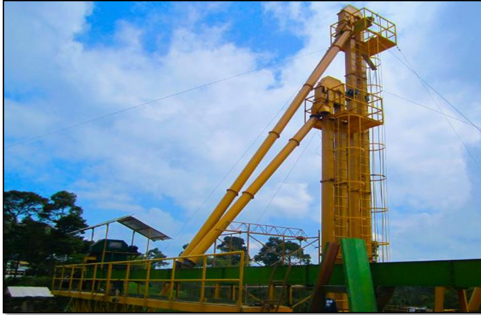
Figura 13. Elevador de cangilones. Adaptada de: Galería GS Ingeniería S.A.S (sf). Disponible en: http://www.gsingenieria.co/gallery . Se accedió: 7 de Abril de 2017
