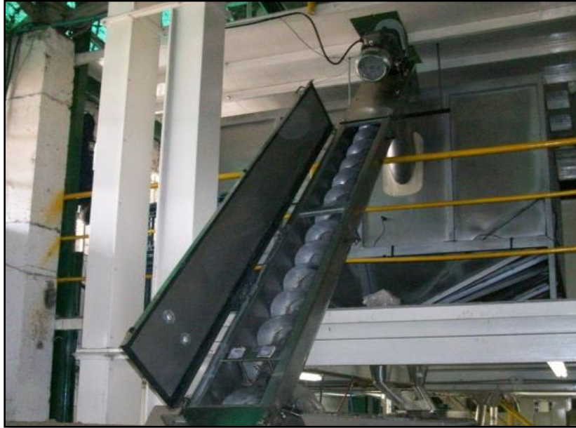
Figura 17. Tornillo Sin Fin. Adaptada de: Dismet. (sf). Disponible en: http://www.dismet.com . Se accedió: 15 de Mayo de 2017
