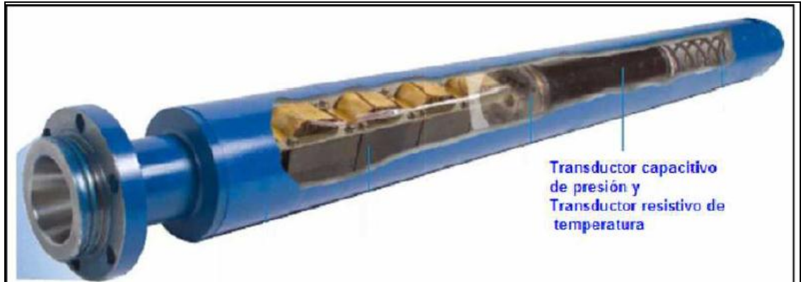
Figura 26. Sensor de Fondo Equipo BES
