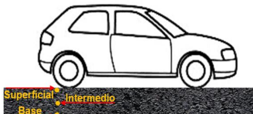
Figura 8. Profundidades de la carpeta asfáltica a evaluar.
