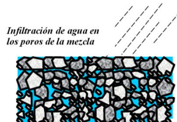
Figura 5. Infiltración de agua en los poros de la mezcla [5]
