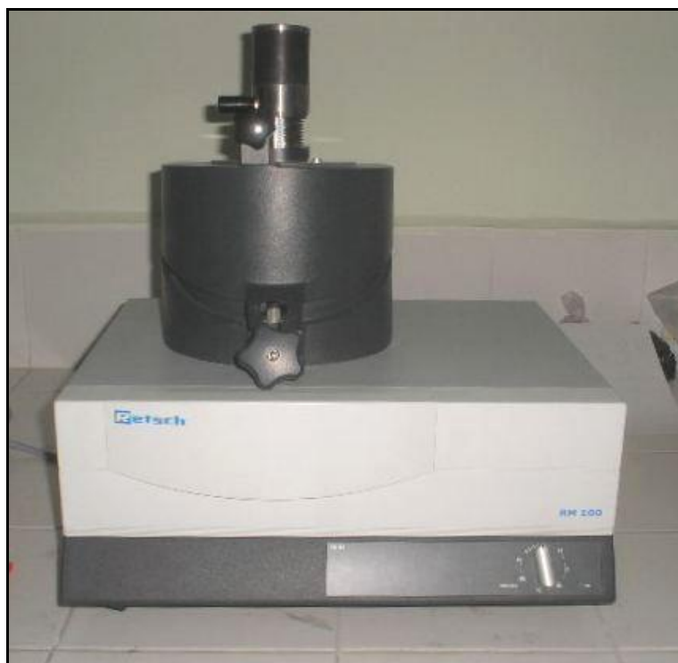
Figura 3 Molino Mecánico con Mortero –RM100, marca Retsch , empleado en el proceso de trituración de muestras para su análisis mediante difracción de rayos X.
