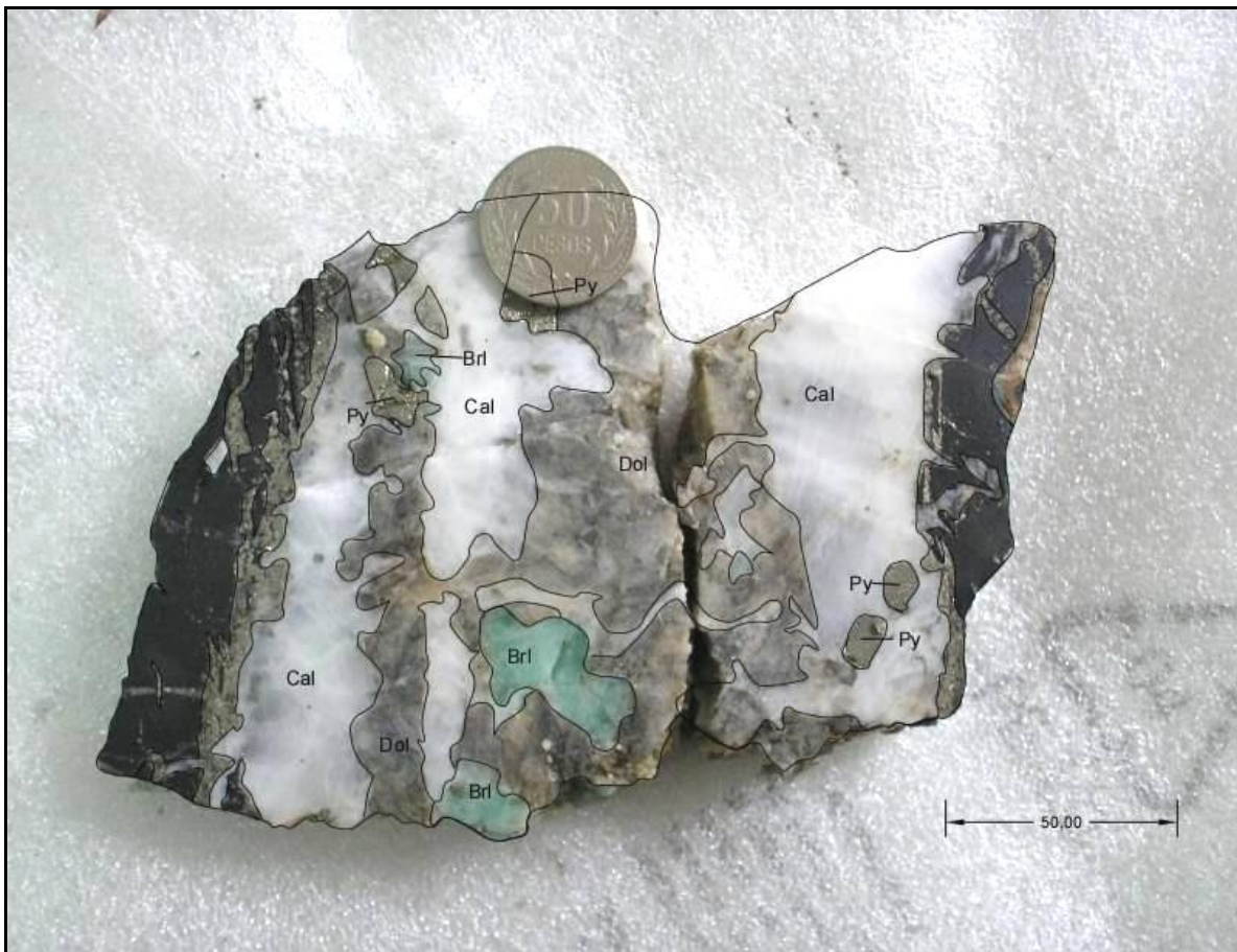
Figura 28 Corte en sección transversal de la muestra de la mina “El Repollal”. El carácter antitaxial de la vena es más evidente en esta vista y las asociaciones paragenéticas en torno al berilo están representadas por la calcita y la dolomita, a sí como la distribución de los cristales de pirita hacia las paredes de la misma.
