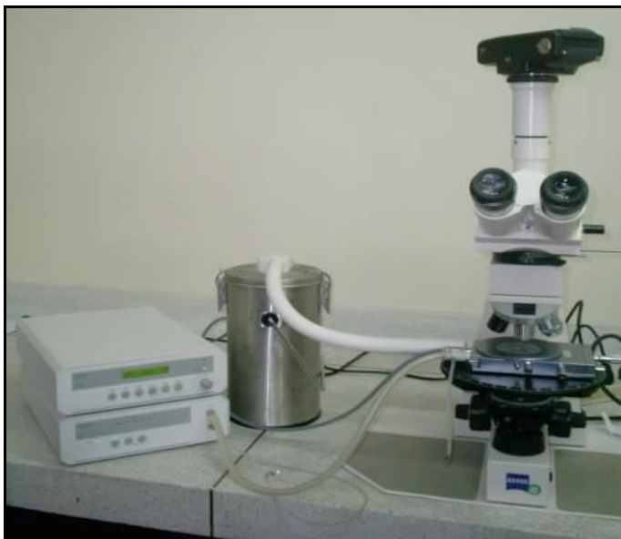
Figura 4 Aspecto del equipo (Platina TH 600 Linkam adaptada a microscopio óptico) utilizado para los estudios microtermométricos de Inclusiones Fluidas (Laboratorio de Geología, sede UIS-Guatiguará).
