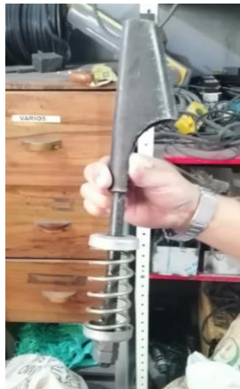
Ilustración 41. Elemento de sujeción entre cables y bastidor.
