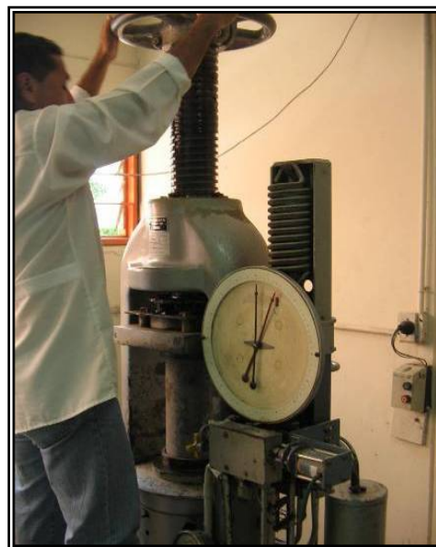
Figura 26: Ensayo de compresión
