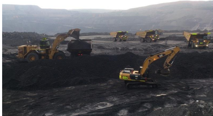
Figura 28. Cargue y acarreo de carbón
