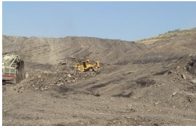
Figura 24. Descapote de manto de carbón con buldócer.
