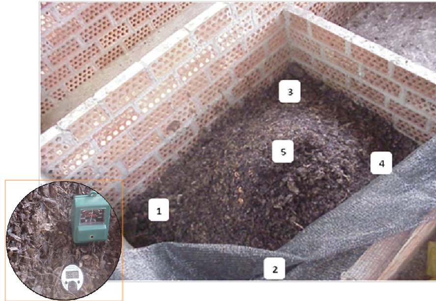
Figura 7. Puntos seleccionados para el seguimiento de los parámetros de pH y temperatura en las pilas de compostaje.
