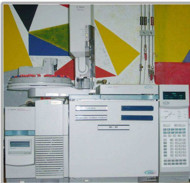
Figura 11. Cromatógrafo de gases Agilent Technologies 6890 Plus Series GC , acoplado a un detector selectivo de masas.
