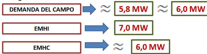
Figura 8. Demanda del Campo Yariguíes, Energía Mínima Horaria Instalada y Energía Mínima Horaria Contratada.
