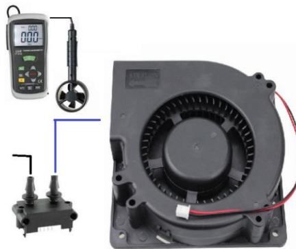
Figura 30. Elementos de medida: Caudal y diferencial de presión
