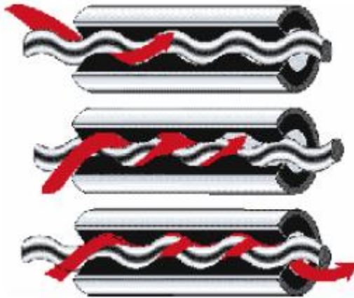
Figura No. 9: Funcionamiento del estator – rotor.
