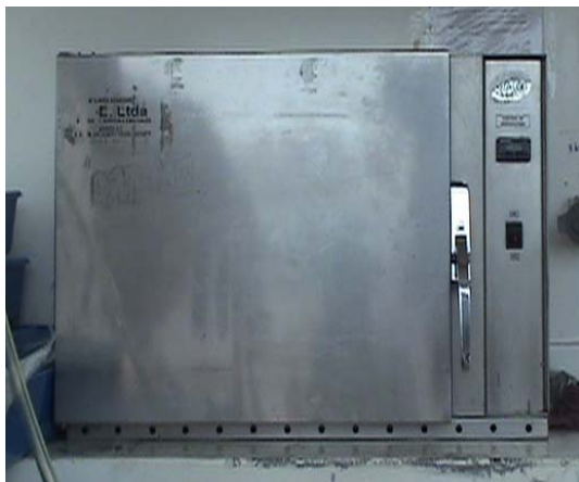
Figura 5.1. Horno utilizado en campo para calcular el porcentaje inicial de agua.
