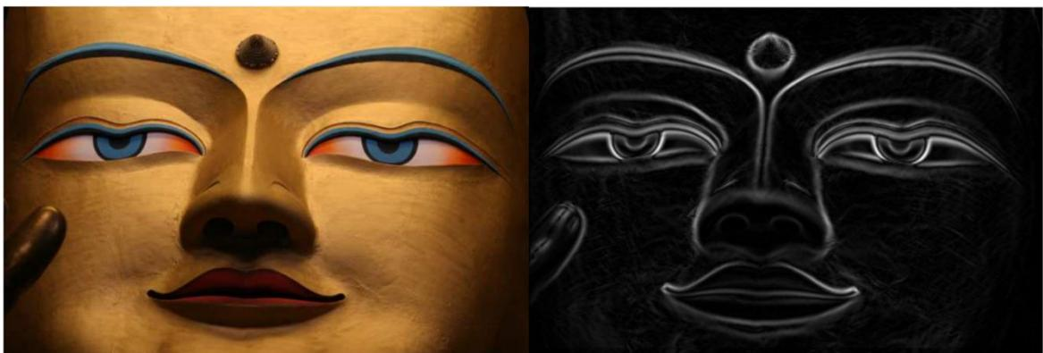
*Nota:* Izquierda, imagen original. Derecha, resultado del cálculo de la magnitud del gradiente aplicado a cada píxel sobre la imagen original en escala de grises. Adaptado de
