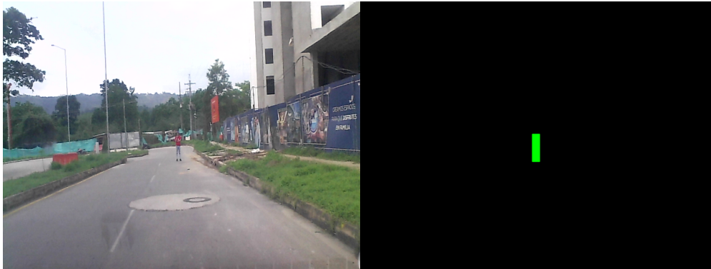
Figura 40. Distancia máxima de detección de la persona con velocidad aproximada de 20km/h.
