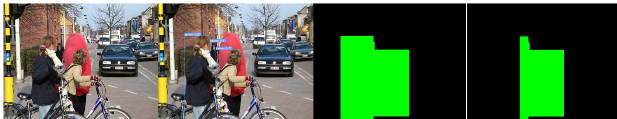
Figura 18. Comparación de una imagen de prueba vs la detección de personas con YOLOv7 original, YOLOv7 modificado y YOLOv7 modificado con filtro.
