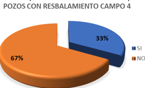
Figura 16. Porcentaje de pozos del Campo 4 con acumulación de líquidos en el pozo.
