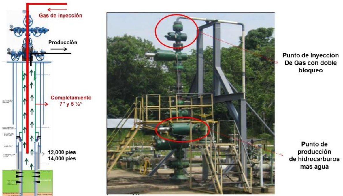
Figura 33. Esquemático de Coiled Tubing Gas lift en superficie y en fondo.
