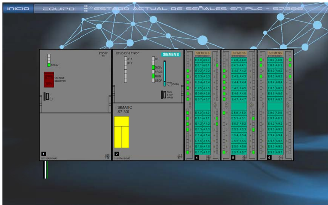
Figura 51. Imagen del controlador Maestro S7-300 desde el sistema SCADA
