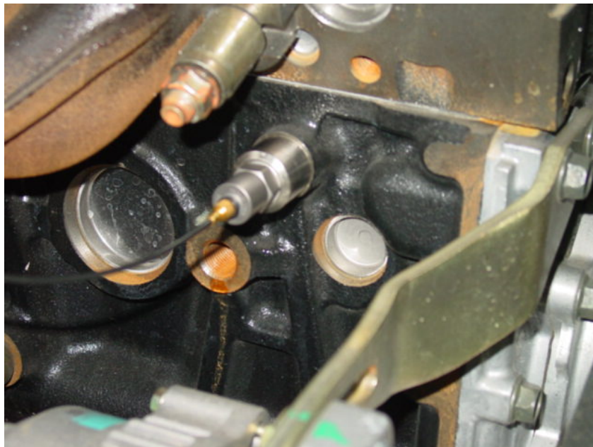
Figura 6. Montaje del acelerómetro en el motor
