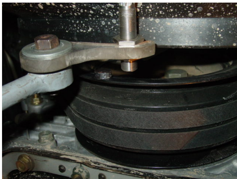
Figura 4. Montaje del sensor para la prueba de Potencia y Par
