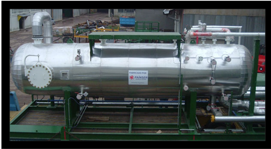
Figura 42. Configuración externa de un separador bifásico horizontal
