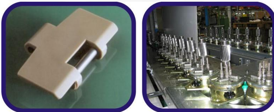
Figura 22. Cadenas de charnela de plástico convencionales.
