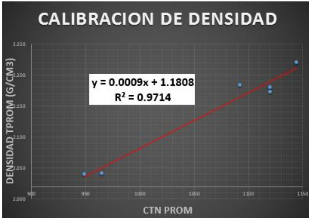
Figura 89. Grafica de calibración realizada con 6 de la muestras de roca.
