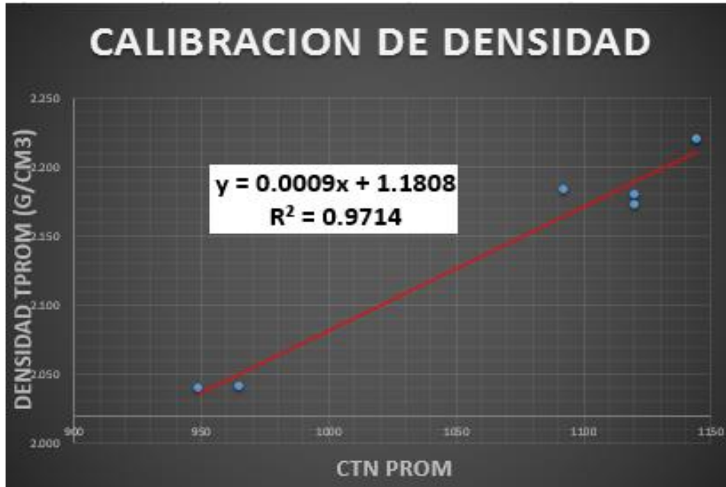
Figura 74. Grafica de calibración realizada con 6 de la muestras de roca.
