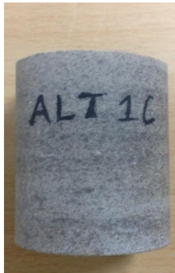
Figura 26. Muestra de roca tipo tapón 2. ALT1C Sintética
