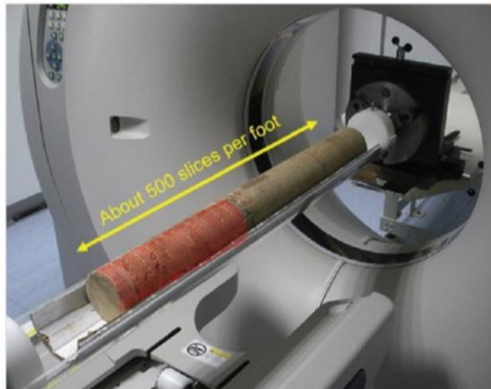
Figura 13. Escaneo tomográfico real para un núcleo.
