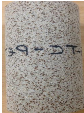
Figura 21. Muestra de roca tipo tapón 1. B-TC-PET-06 Berea
