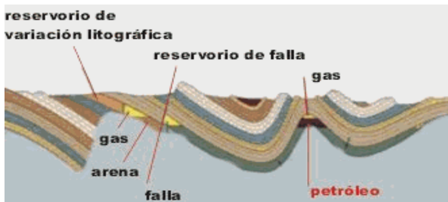
Figura 3. Variación litológica, fallas y pliegues de información geológica.
