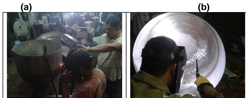
Figura 61. Suelda del tanque (a) parte exterior, (b) parte interior
