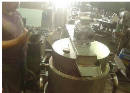
Figura 65. Montaje del moto reductor
