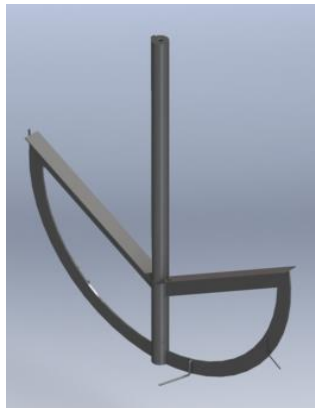
Figura 31. Renderización de las paletas y el eje
