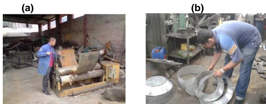
Figura 60. Doblado de planchas de metal (a) proceso, (b) resultado
