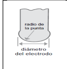
Figura 59. Detalle punta electrodo tungsteno
