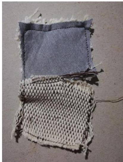
*Figura 44.* Probeta de costura después de la prueba de tensión
