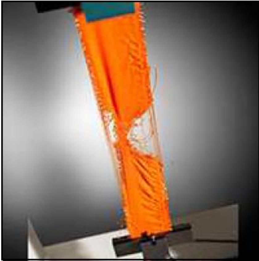
*Figura 35.* Ensayo de probeta por método de tiras. Adaptado de E. Carrera (2015). Caracterización de tejidos.
