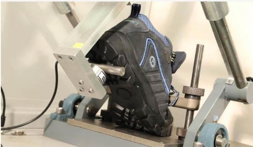
*Figura 37.* Prueba de doblez y flexión al material del calzado. Adaptado de Reinventando el calzado (s.f). Satra, laboratorio experto en calzado. Parte ii de <https://reinventandoelcalzado.es/satra-laboratorio-experto-en-calzado-parte-ii/>
