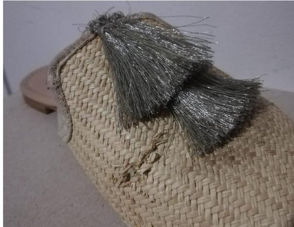
*Figura 51.* Daño en la capellada por uso en el calzado de fique convencional
