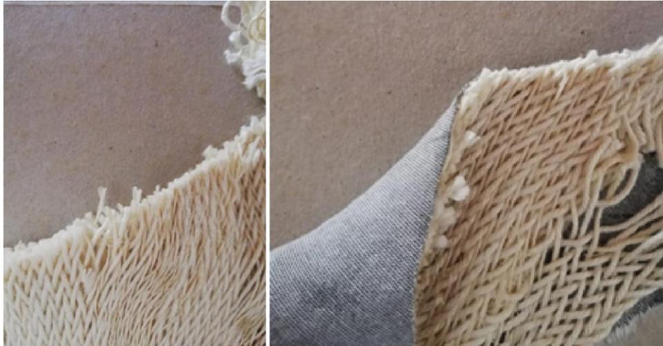
*Figura 41.* Preparación del material para prueba de costura. A la izq. Unión 2 capas de Sprang, a la dcha. Unión de tejido con tela de punto
