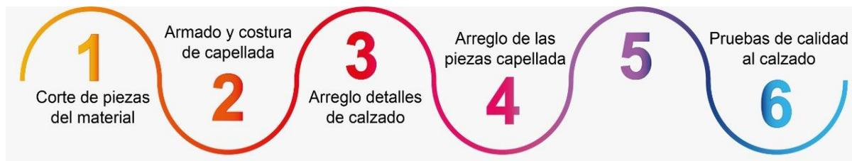
*Figura 29.* Proceso de fabricación y validación del prototipo de calzado
