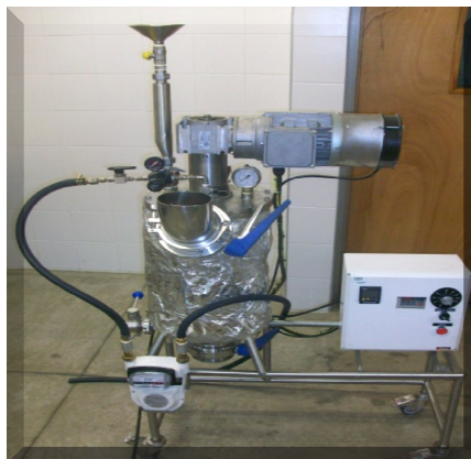
Figura 2.1 Esquema del reactor anaerobio de 23 l Fuente: El Autor
