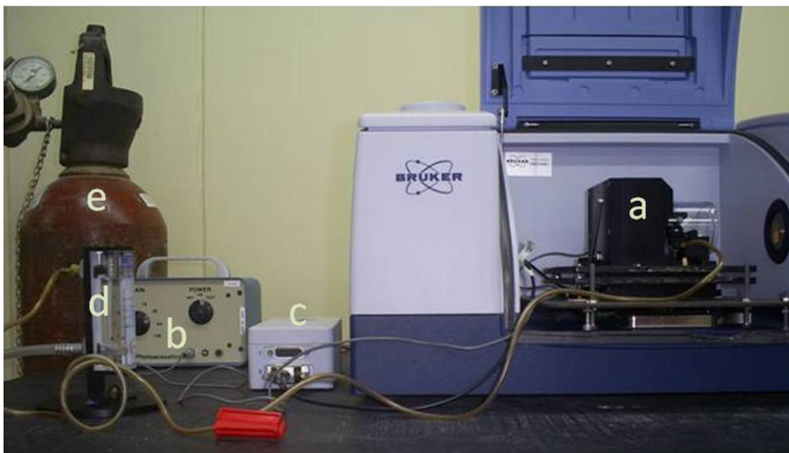
Figura 10. Sistema PAS acoplado al equipo IR Tensor 27 marca Bruker
