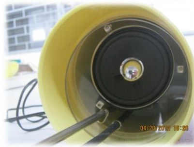
Figura 17. Detalle del bafle con soporte de acrílico. Fuente: [Autor]
