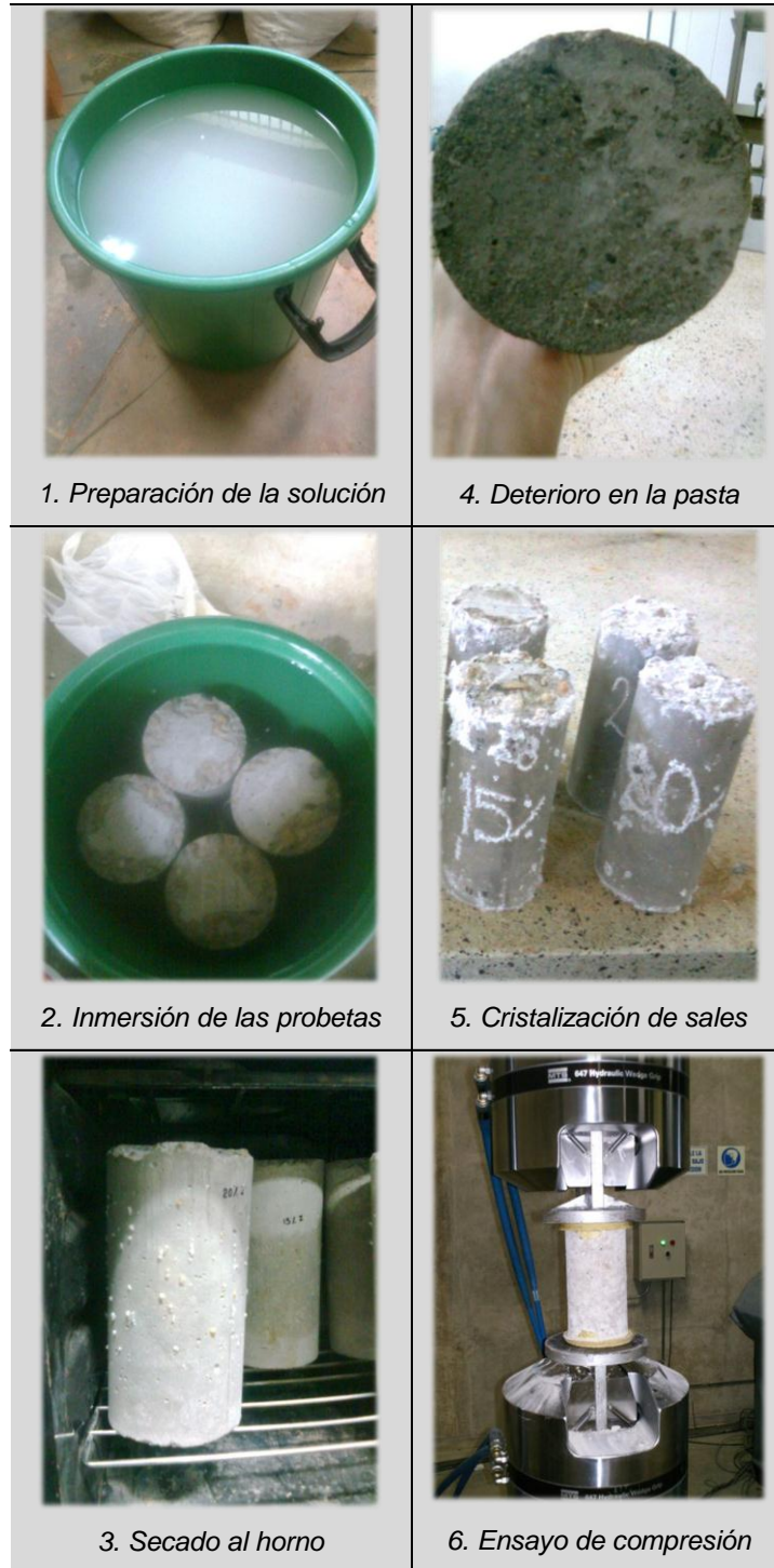
Figura C1 Secuencia fotográfica del proceso de sulfatación. Fuente [Autor]
