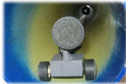
Figura 16. Detalle del sistema móvil varilla-micrófono. Fuente: [Autor]
