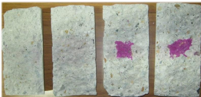
Figura 24. Profundidades de carbonatación para el 0, 10, 15 y 20% de sustitución Fuente: [Autor]
