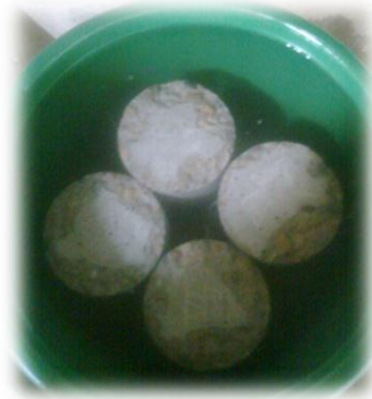
Figura 11. Inmersión de probetas en la solución de sulfato de sodio anhidro. Fuente [Autor]
