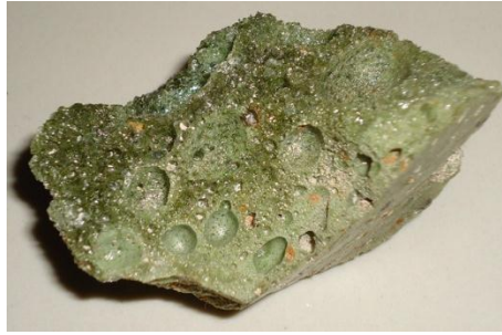
Figura 6. Apariencia de la escoria de horno de cubilote. Fuente: [El autor].
