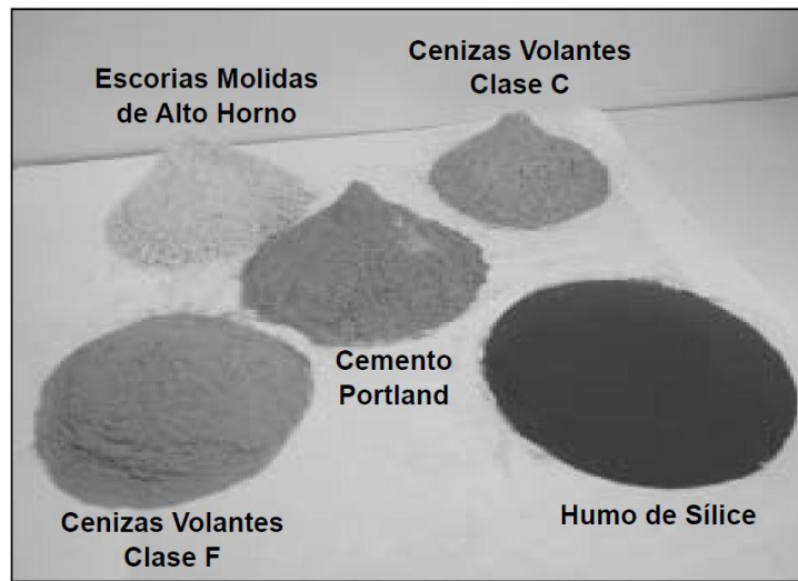
Figura 5. Algunas sustancias aprovechadas como adiciones de cemento. Fuente: [33].
