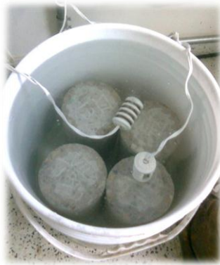
Figura 12. Inmersión de probetas en agua a 80°C. Fuente [Autor]
