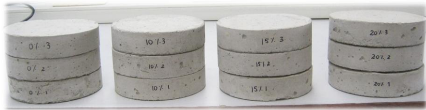
Figura 10. Discos de concreto utilizados en el ensayo de tubo de impedancia. Fuente [Autor]
