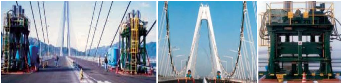
Figura 6. Pruebas de excitación forzada en los puentes Tataru y Yeongjong.
