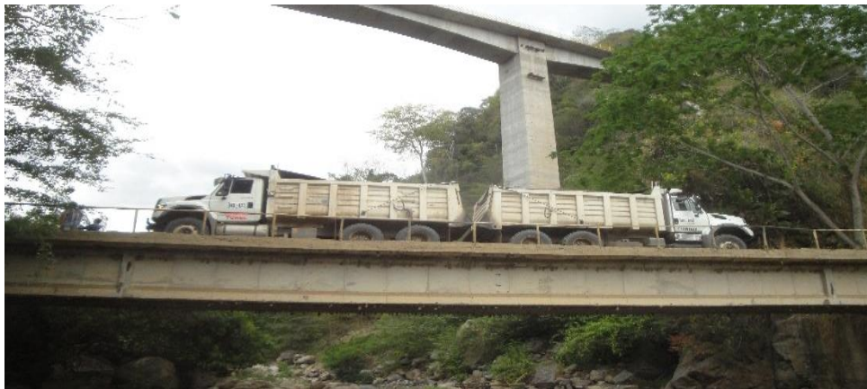
Figura 9. Puente El Ramo: (a) Pruebas estáticas, (b) Pruebas dinámicas.
