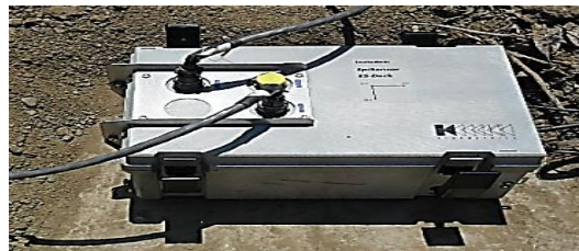
Figura 15. Equipo utilizado en la medición de vibraciones. (a) Consola K2 Kinometrics, (b) Episensor triaxial FBA ES-T, (c) Computador portátil, (d) Planta eléctrica.
