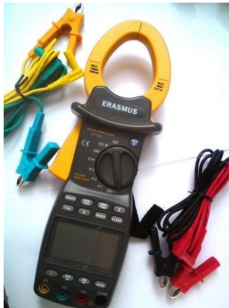
Figura 52. Pinza digital medidora de potencia de tres fases
