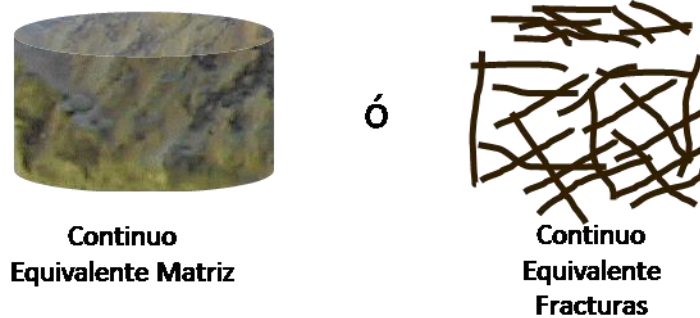
Figura 7. Representación física del yacimiento en los Modelos de Única Porosidad.
