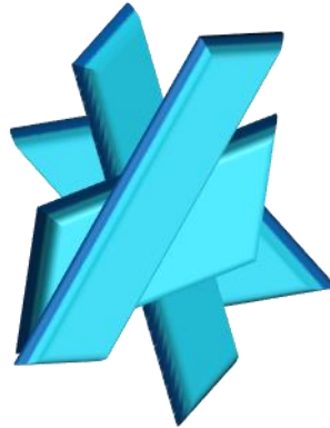
Figura 5. Representación física de las fracturas en el Modelo de Snow.
