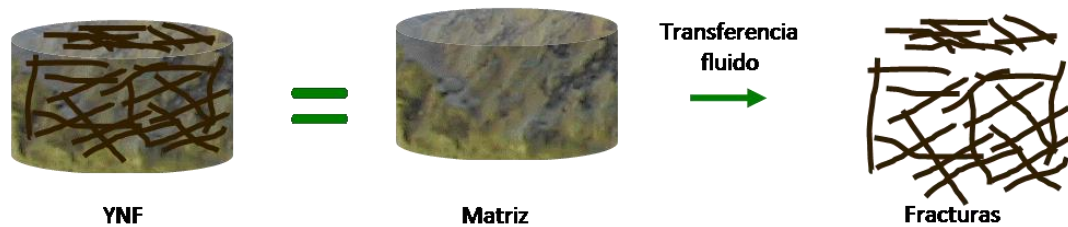
Figura 8. Representación física del yacimiento en los Modelos de Superposición de Continuos.
