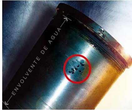
Figura 19. Presencia de Corrosión por Picadura
