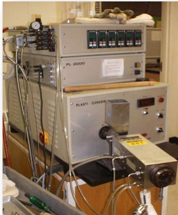
Figura 13: Extrusora de un tornillo Brabender Plasti-corder Extruder Model PL 2000, Hackensack, NJ.
