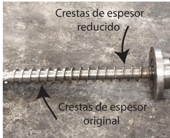
Figura 92: Reducción del espesor de la cresta del tornillo (16).
