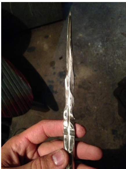
Figuras 38. Pruebas de forma realizadas con esmeril, lijadoras de banda y pulidoras, para tallar la pieza metálica.
