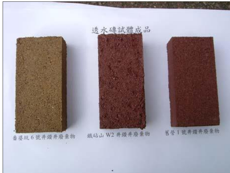
Figura 59. Bloques construidos a partir de ripios de perforación.
