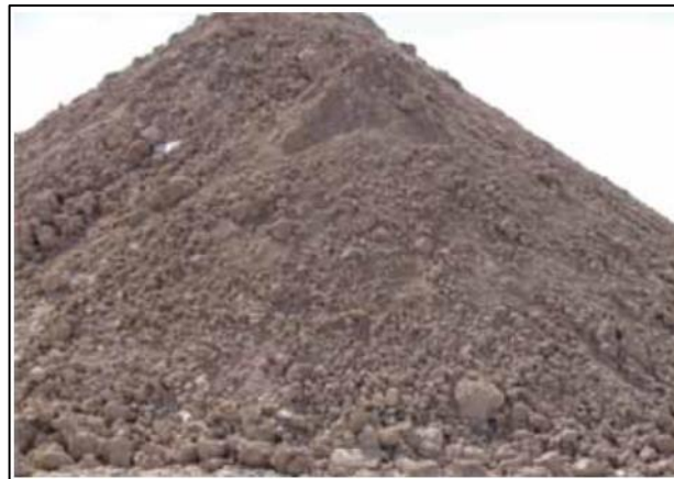
Figura 60. Mezcla de ripios con material calcáreo.
