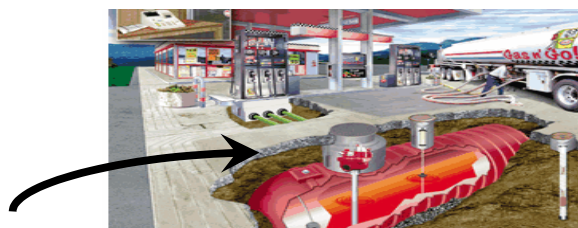
Figura 5. Imagen de sistema de chip integrado a tanques de almacenamiento Fuente: www.insepet.com
