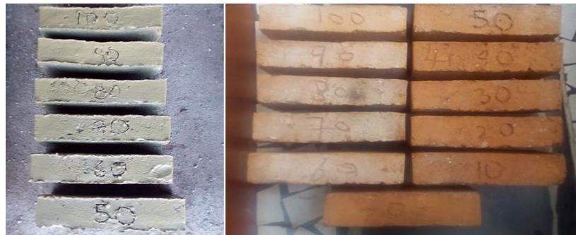
Figura 5. A) Ladrillos después de moldeados B) Ladrillos después de cocidos
