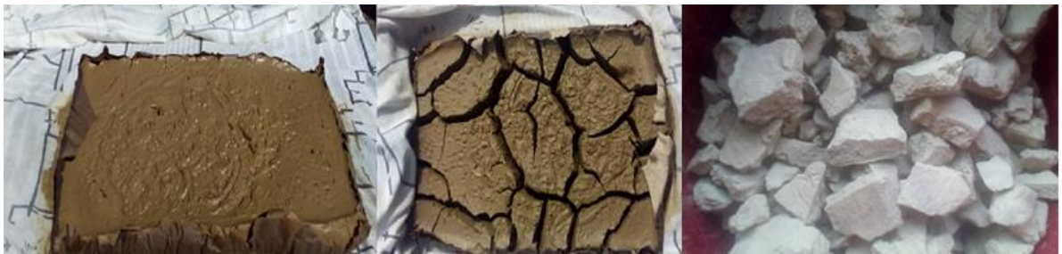
Figura 4. Lodo después de 3,5 y 8 días de secado.
