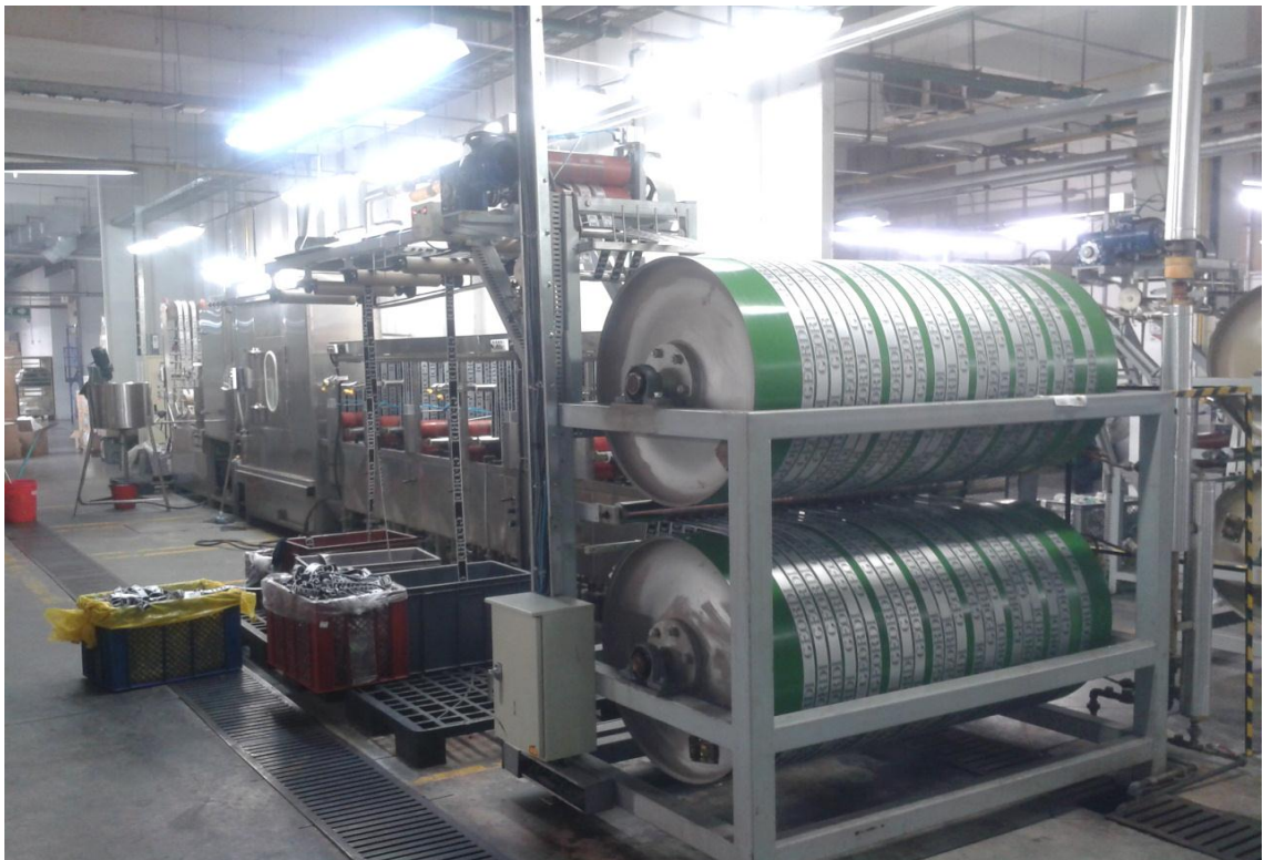
Figura 19. Teñidora de cintas Donguan, planta Dugotex
