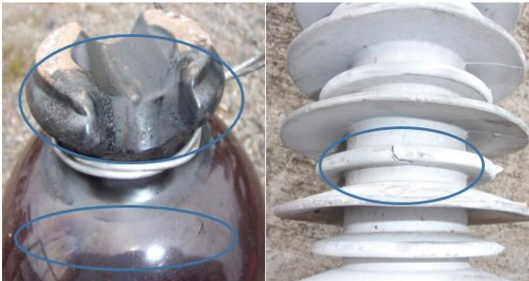
El envejecimiento y daño del equipo no es constante, su deterioro es progresivo, inicialmente con la aparición de pequeños caminos o ramales. Posteriormente con la polución y la humedad se generan caminos para que se produzca un salto de energía más prolongado hasta causar su ruptura [12]. Ricardo Albarracín Sánchez en su tesis doctoral describe tres estados en el que evolucionan las descargas parciales:
