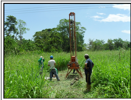
Ilustración 6. Ejecución de Sondeos
