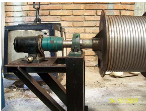
Figura 11. Soporte del motor
