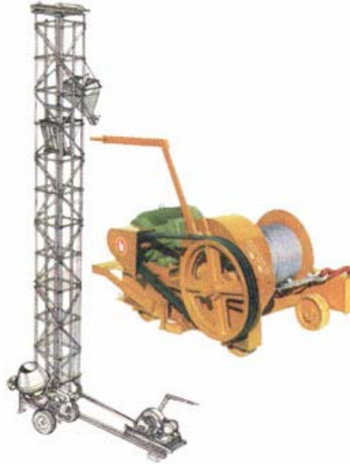
Figura 4. Tambor de arrollamiento para elevador de tracción.
