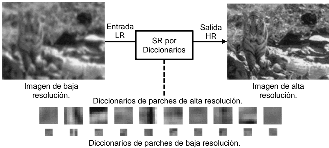
Figura 7: Representación esquemática del proceso de superresolución por entrenamiento de diccionarios.
