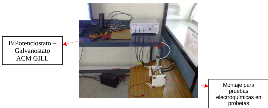
Fotografía 2. La Celda Plana conectada al Bi-Potenciostato ACM GILL conectado a una computadora con software ACM versión 5.0
