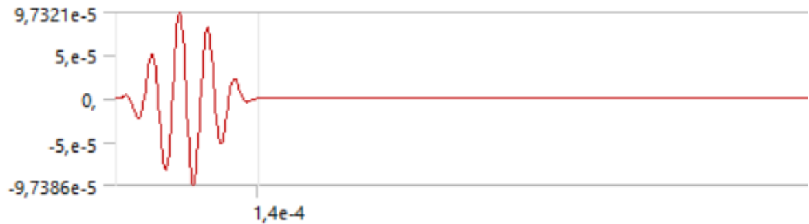
Figura 14. Comportamiento de la onda guiada en ANSYS según la ecuación.
