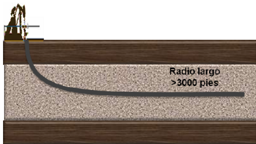
Figura 8. Pozo Horizontal de radio largo
