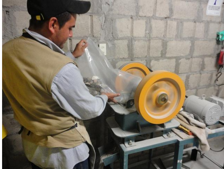
Figura 37. Imagen de la trituradora para procesar duplicados
