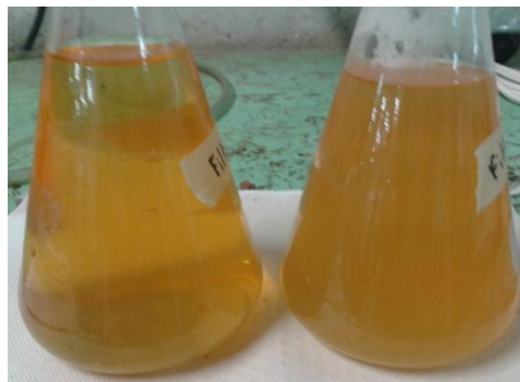
Figura 14. Clarificado de hidrolizado de harina de yuca en filtro prensa con medio filtrante de Drill super ocho (izquierda) y lienzo (derecha), alimentación con presión a 25 psi, temperatura de filtración= 70°C e hidrólisis realizada con una concentración de 10%p/v (harina de yuca integral/agua).
