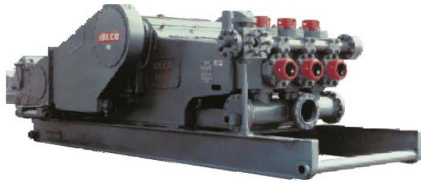
Figura 7. Bomba de lodos, parte esencial del sistema de circulación
